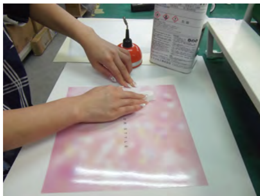
③ ローラーで取れないゴミ、糊カスはクリーニングペーパーにクリーニング液を少量含ませてふき取ります。
