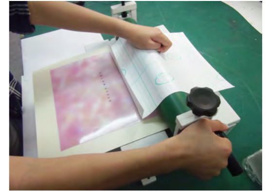
⑧ ラミネートフィルムの裏紙（剥離紙）ごとフィルムを持ち上げます。
